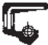
SC Anello in gomma con armatura metallica interna e labbro tenuta caricato a molla
