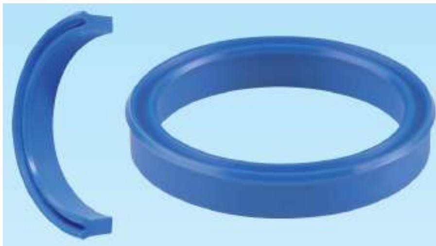
IL tipo TTI è indicato per la tenuta su stelo. Come tutte le guarnizioni realizzate con il poliuretano annovera tra le sue principali caratteristiche un elevato modulo elastico, una bassa deformazione ed una buona resistenza all'abrasione, mentre il suo particolare profilo asimmetrico garantisce un'ottima tenuta e affidabilità.
