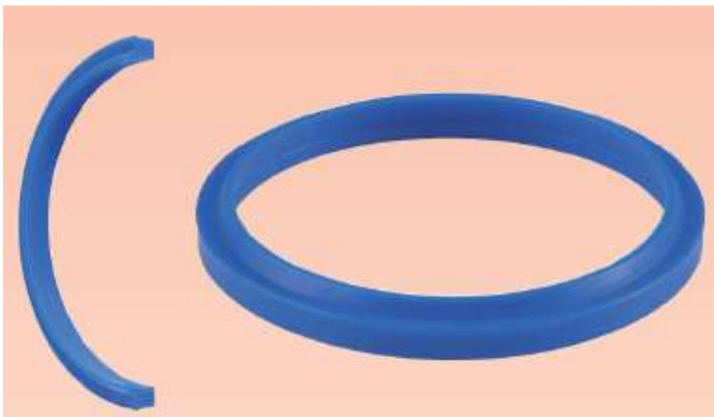
I raschiatori tipo GHK, in materiale poliuretano, rappresentano un componente essenziale per la protezione dei vari organi nelle apparecchiature oleodinamiche e pneumatiche. Il compito principale è quello di impedire la possibilità di infiltrazioni nei cilindri di polvere, fango o qualsiasi altro corpo estraneo al fluido, che oltre a compromettere il funzionamento delle guarnizioni di tenuta, per la loro azione abrasiva, danneggerebbero la superficie dei cilindri e degli steli.
