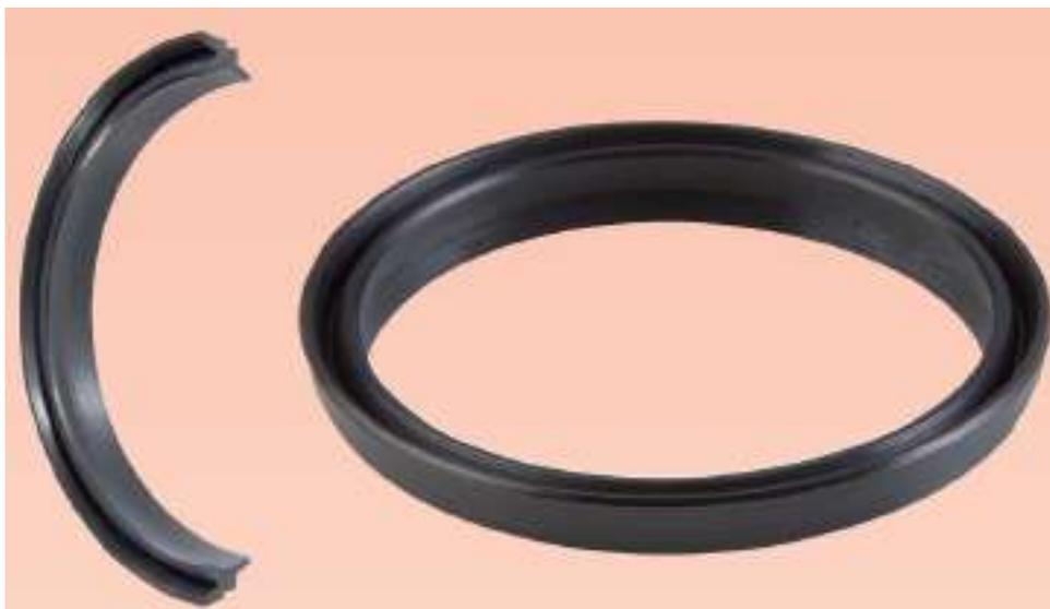
Gli anelli raschiatori tipo GCF, realizzati in poliuretano, svolgono la duplice funzione di raschiamento e di tenuta in un unico elemento. Oltre a svolgere la funzione di protezione impedendo l'entrata di polveri, fango sporco e detriti di metallo che potrebbero causare rigature dello stelo, la presenza di un secondo labbro garantisce massima tenuta anche in caso di trafilamento del fluido. Sono particolarmente indicati per cilindri industriali e per macchine agricole e movimento terra.
