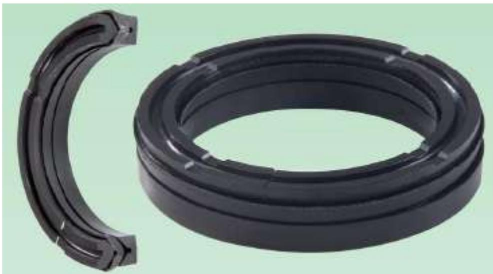
La guarnizione a pacco GT3 è adatta per il montaggio su pistoni di cilindri idraulici a doppio effetto. Composta da tre elementi – anello di tenuta a “V”, anello di sostegno ed anello di pressione – è interamente realizzata in tessuto gommato elastico impregnato con elastomero nitrilico che le conferisce lunga durata e forte resistenza all’estrusione anche in presenza di forti pressioni ed alte velocità di scorrimento.
