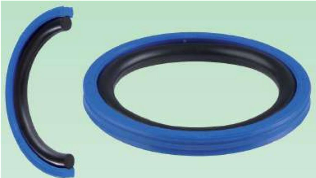
Il tipo TTO è indicato per la tenuta su pistone. E' composto da un elemento di tenuta in poliuretano, caratterizzato da un elevato modulo elastico, bassa deformazione e buona resistenza all'abrasione, e da un anello O-Ring in NBR.
