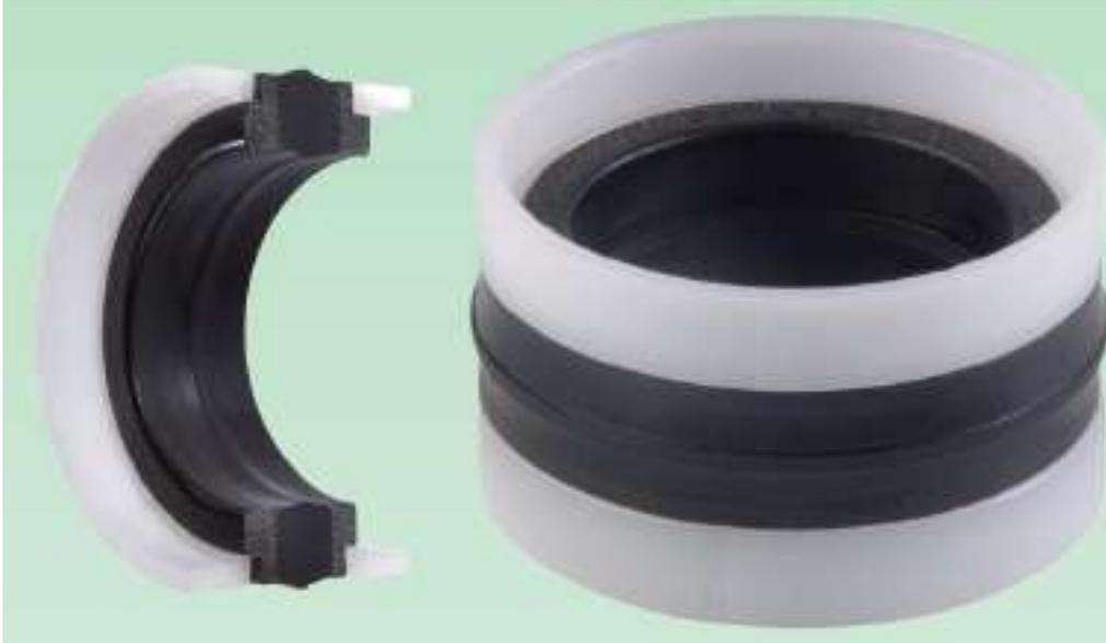
La TDE è una guarnizione costruita per essere utilizzata su pistoni a doppio effetto in due pezzi. La parte centrale è realizzata in cotone + NBR per supportare elevati carichi di rottura conferendo alla guarnizione la possibilità di resistere all'abrasione e all'usura della parte di contatto; gli anelli di guida sono realizzati in resina acetale per supportare l'eventuale estrusione in presenza di alte pressioni.
