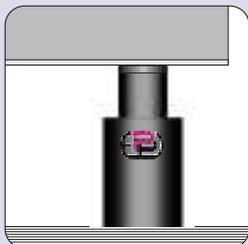
**N**on usate mai senza testina cilindri che ne siano dotati, per evitare rigonfiamenti dello stelo. Le testine ripartiscono uniformemente il carico sullo stelo.
