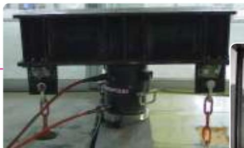
Prove di resistenza e di inflessione effettuate su solai o travi tramite cilindri a semplice o doppio effetto EUROPRESS.
