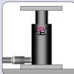
**A**ssicuratevi che le due zone sulle quali il cilindro sviluppa la sua forza, siano sufficientemente solide ed indeformabili.
