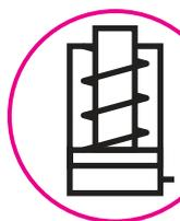
**Ritorno a molla**, nel quale una molla alloggiata all'interno del cilindro e messa in tensione dall'uscita del pistone fornisce la forza di rientro; sono da preferirsi qualora, in utilizzi non continuativi, si
