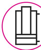
**Ritorno ad olio**, nel quale il rientro è ottenuto idraulicamente, pompando olio nella camera di ritorno del cilindro.
