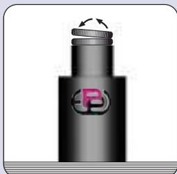
**E**vitare il sollevamento di carichi fuori asse che potrebbero danneggiare irrimediabilmente il cilindro. L'utilizzo di una testina autolivellante consente un disassamento del carico di  $\pm 5^\circ$ .
